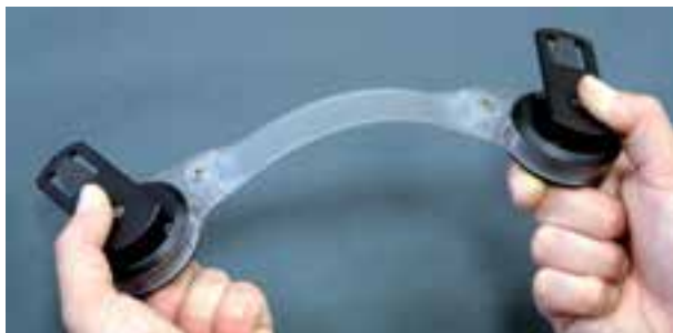
Figure 5a, 5b, 5c. Il dispositivo ha una barra dotata di caratteristiche meccaniche di elasticità tali da permettere la flessione e lo svergolamento della stessa da parte del bambino senza uscire dal campo di deformabilità in regime elastico della barra stessa ed il successivo ritorno alla posizione originaria a causa della forza elastica di richiamo esercitata dalla barra elastica.
